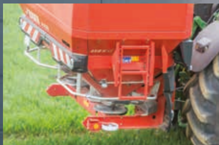
AXIS H - Разпръскване в крайна зона отляво и отдясно чрез регулиране на оборотите и точката на подаване
